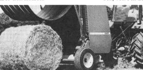
Die Vorverdichtung durch die neuen, einstellbaren Niederhalter, beginnt direkt an der Pick-up und bleibt stets konstant, unabhängig sowohl von der Höheneinstellung als auch von möglichen Bodenwellen.
