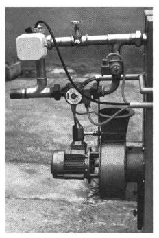
Abb. 2: Angebauter Rauchgas-Saugzugventilator.
