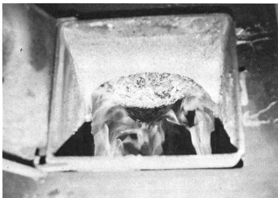
Abb. 4: Kontinuierlicher Schnitzelfluss in den Brennraum. Im kleineren hellen Haufen sind frisch zugeführte Schnitzel, im grösseren dunklen Haufen sind Schnitzel, die von unten her abgebrannt werden.
