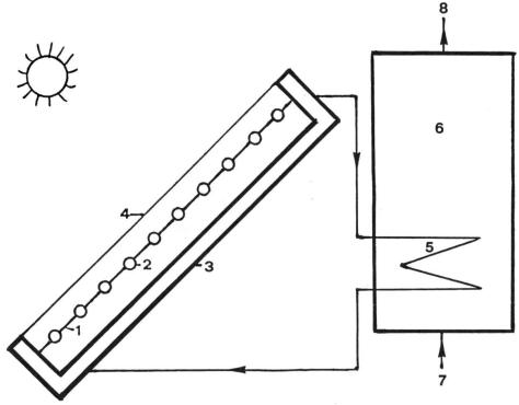
Abb. 2: Schematischer Aufbau eines Sonnenkollektors: Der Warmwasserkollektor besteht aus einem Absorber (1) der die eingefangene Sonnenwärme an durch die Rohrleitungen (2) fliessendes Wasser abgibt. Der Kasten (3) ist in der Regel isoliert und auf der Sonnenseite mit einer durchsichtigen Platte (4) abgedeckt. Im Wärmetauscher (5) erfolgt der Wärmeeintritt vom Kollektorkreislauf auf den Speicherinhalt. (6) = Wassertank, (7) = Wassereinspeisung, (8) = Warmwasser zum Verbraucher.
