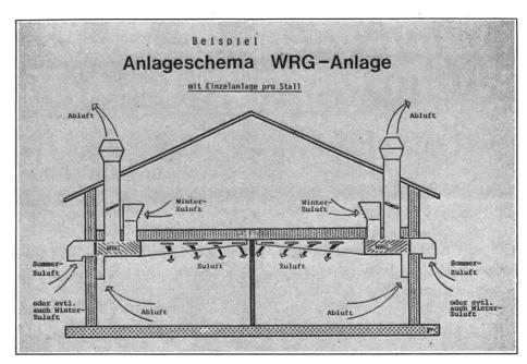
Abb. 2 a + b: Schema einer WRG-Anlage (1 Stall, 2 Ställe).
