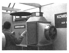
Abb. 3: Kreuzstrom-Wärmetauscher aus Kunststoffplatten gut demontierbar.
