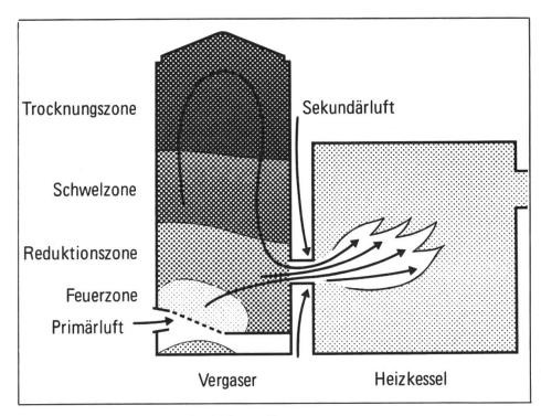
Abb. 5: Funktionsschema des Holzgas-Brenners.
