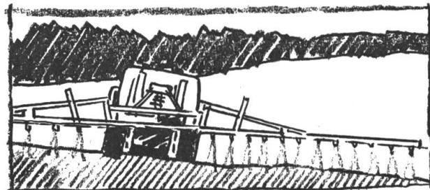
Mehrfachdüsen sind die einfachste und bequemste Lösung. Es braucht keine zeitraubenden Düsenwechsel. Durch die Schrägstellung der Düsen bis max. 20° nach vorn bzw. hinten wird eine bessere Penetration der Tropfen erreicht.
