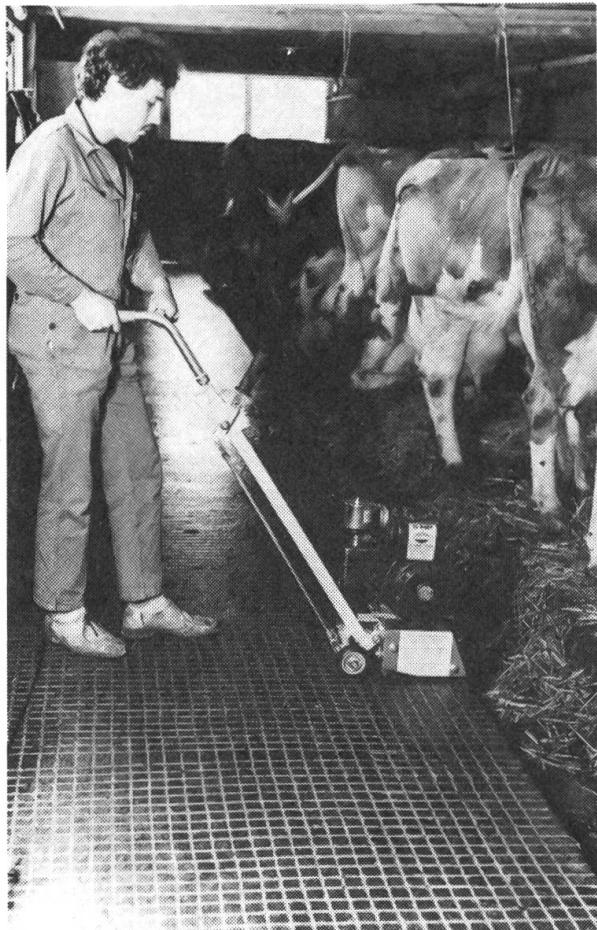
Um die Ausrutschgefahr auf glatten Böden zu verhindern, können diese Oberflächen mit der Von Arx-Flächenbearbeitungs-Maschine FR-200 längs- oder kreuzweise rilliert werden.
