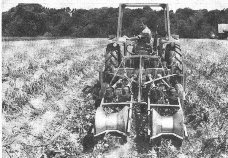
Abb. 6: Beim Einsatz der Krautziehmaschine Nimos (keine Vertretung in der Schweiz) wird das Kraut auf eine Reststengellänge von 30 bis 35 cm abgeschlagen und in der Folge mit den Gummiriemen (rechts) ausgezogen. Bei einer wählbaren Riemengeschwindigkeit von 2,5 bis 3,2 m/s liegt der optimale Fahrgeschwindigkeitsbereich zwischen 2,6 und 3,5 km/h – hohe gleichmässig geformte Dämme und richtige Maschineneinstellung vorausgesetzt.
