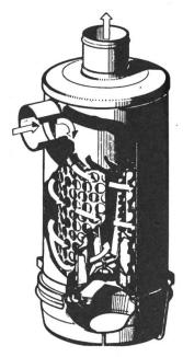
Abb. 3: Querschnitt durch einen Trockenfilter.
