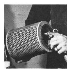
Abb. 4: Ausblasen einer Trockenfilter-Patrone.
