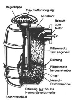
Abb. 2: Querschnitt durch einen Oelbadluftfilter.
