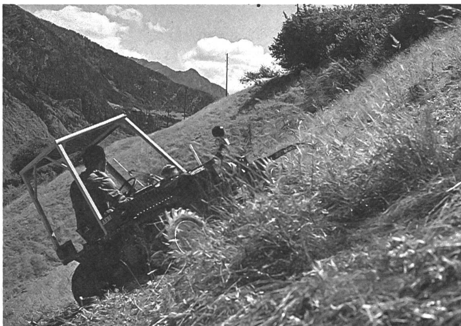
Abb. 3: Der kleine Zweiachsmäher, speziell konstruiert für die extreme Hangmechanisierung, ist in steilen Lagen den Mähtraktoren immer noch überlegen.
