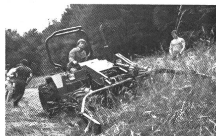
Abb. 2: Ein Mähtraktor, ausgerüstet mit Doppel-AS-Bereifung hinten und Terrabereifung vorne macht das Fahrzeug hangtauglich, aber auch teurer.
