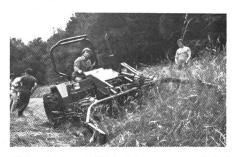
Abb. 2: Ein Mähtraktor, ausgerüstet mit Doppel-AS-Bereifung hinten und Terrabereifung vorne macht das Fahrzeug hangtauglich, aber auch teurer.
