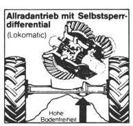
Die Allrad-Vorderachse ist auch unter härtesten Einsatzbedingungen voll belastbar. Das automatische Selbstsperrdifferential steigert die Zugkraft und die Leistung besonders bei schwierigen Bodenverhältnissen.
