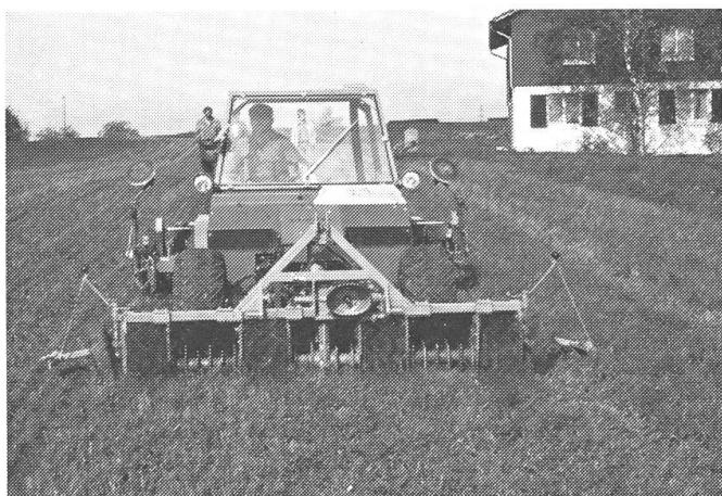
Abb. 2: Die umgebaute Bodenfräse bearbeitet einen Saatstreifen von rund 25 cm.
