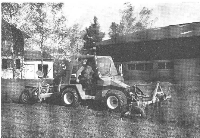
Abb. 1: Traktor TM 1000 mit Reihenfräse an der Front- und Einzelkornsämaschine an der Heckhydraulik.
