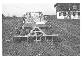
Abb. 2: Die umgebaute Bodenfräse bearbeitet einen Saatstreifen von rund 25 cm.
