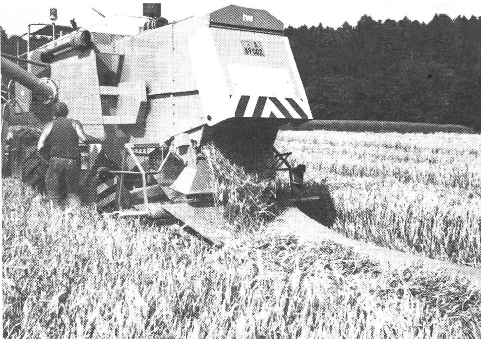
Abb. 1: Mähdrescher-Messversuche: Das an der Maschine austretende Kurz- und Langstroh wird mit zwei Tüchern aufgefangen. Gleichzeitig werden die Zeit und der Treibstoffverbrauch gemessen.
