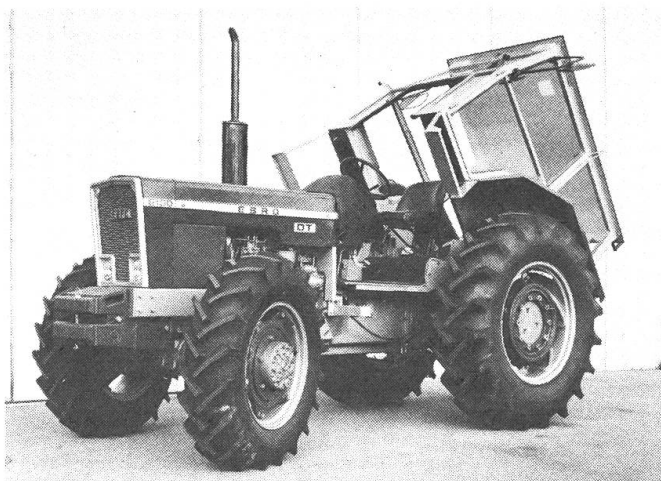
Abb. 3: Kippkabine erleichtert Service und Reparaturen.
