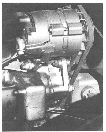
Abb. 1: Keilriemenwechsel erschwert – Hydraulikpumpe demontieren!
