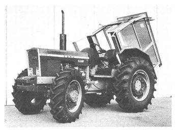
Abb. 3: Kippkabine erleichtert Service und Reparaturen.
