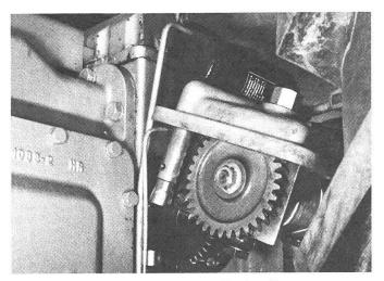
Abb. 4: Abnehmbarer Deckel mit Hydraulikpumpe und Ölfilter.
