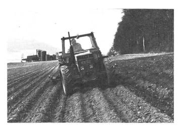
Abb. 11: Beim Hangackerbau wurden mit Allradantrieb kleinere Schlupf- und Abtriftwerte gemessen.
