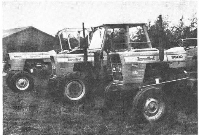
Abb. 1: Im Versuch eingesetzte Traktoren: Normaltraktor und Allradtraktor mit gleicher Leistung und stärkerer Normaltraktor mit gleichem Preis wie Allradtraktor.
