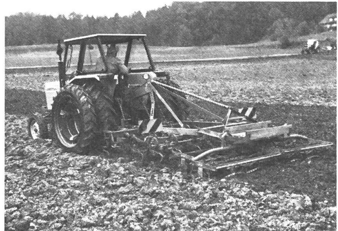
Abb. 7: Mit der Doppelbereifung konnte der Schlupf massgebend verringert werden.
