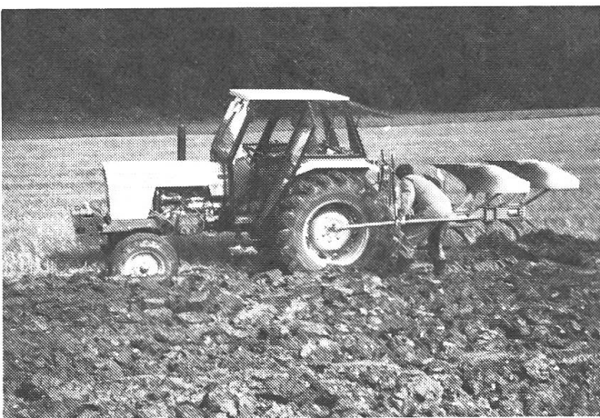
Abb. 5: Beim Pflügen konnte mit dem stärkeren Normaltraktor in praktisch allen Einsätzen in einem um eine Stufe höheren Gang gefahren werden.
