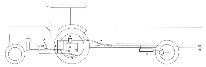
Abb. 11: Hydraulische Anhängerbremse, Bedienung mit dem Bremspedal des Traktors und Ansteuerung durch die hydraulische Traktorbremse.
