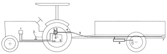
Abb. 10: Einfachste Variante einer hydraulischen Anhängerbremse: Bedienung mit einem Handhebel.
