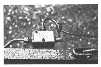
Abb. 3: Das Lastanpassungsventil ersetzt das Anhängerbremsventil nicht. Aus praktischen Überlegungen sollte es auf dem Traktor montiert werden.
