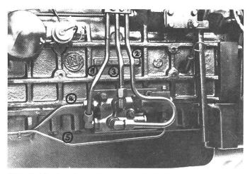
Abb. 5: Ein Anhängerbremsventil mit Rohrverschraubungen:
