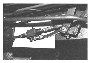
Abb. 4: Der Druckgeber wird bei Traktoren mit mechanischen Bremsen in das Bremsgestänge eingebaut.
