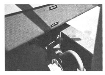
Abb. 2: Umstellhahn «Kippen – Bremsen»: gefährliche Situationen können bei Verwechslung entstehen!
