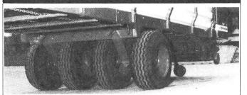
Die optimale Last- und Bodendruckverteilung
