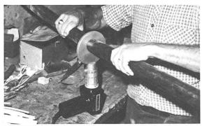
LEISTER beim Stumpfschweissen von Polyäthylen-Rohren.
