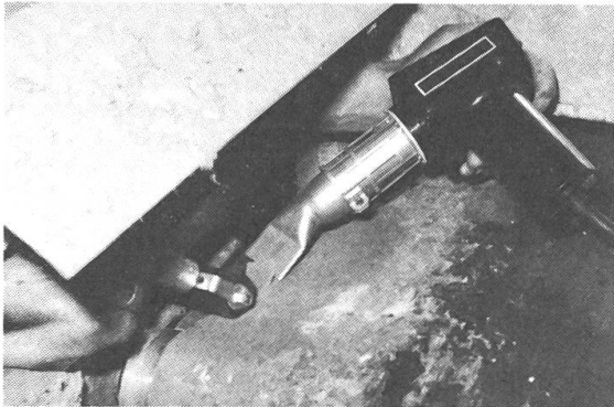
LEISTER beim Verschweissen von PVC- und Polyäthylen-Folien.
