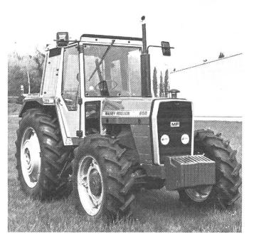
laufende und hydraulisch betätigte Mehrscheibenbremsen, hydraulische Motorzapfwelle 540 und 1000 U/min (unter Last schaltbar), die Massey-Ferguson Regelhydraulik mit einer durchgehenden Hubkraft von 3500 kp, 2 hydraulische Zusatzsteuergeräte mit 4 Anschlüssen, das automatische Anhängerbremsventil sowie die neue De Luxe-Kabine, voll integriert, mit einer 100%-igen Vollrundsicht und modernster Ausrüstung.
