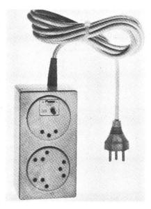
Abb. 4: Mobile FI-Schutzschalter-Steckdose, Sicherheit aber nur von der Steckdose des FI-Schutzschalters bis zum Verbraucher (ca. Fr. 180.–).
