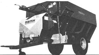
Mit Schnecken- oder Rührflügelmischwelle. Wagentypen von 4–12 m³.
