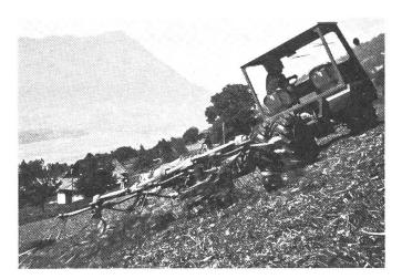
Abb. 2: Wo der Kreiselheuer durch den Transporter angetrieben wird, muss das Ladegerät rasch und leicht gewechselt werden können, weil dieser Wechsel während der Heuernte täglich vorgenommen wird.
