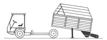
Abb. 1: Die Aufbaugeräte werden heute normalerweise über zwei Hilfsstützen unter Ausnützung der Schwerpunktlage abgestützt.
