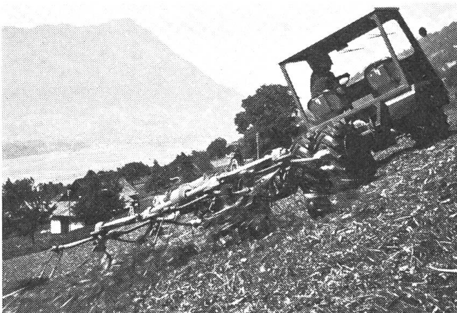
Abb. 2: Wo der Kreiselheuer durch den Transporter angetrieben wird, muss das Ladegerät rasch und leicht gewechselt werden können, weil dieser Wechsel während der Heuernte täglich vorgenommen wird.
