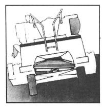
Vollautomatischer Hangausgleich der gesamten Reinigung
