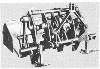
Die Spatenmaschine ermöglicht eine Bodenbearbeitung von bis 35 cm auch in schwierigen Verhältnissen ohne Schmierschichtbildung.
