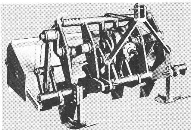
Die Spatenmaschine ermöglicht eine Bodenbearbeitung von bis 35 cm auch in schwierigen Verhältnissen ohne Schmierschichtbildung. Lieferbar in verschiedenen Arbeitsbreiten für Traktoren von bis 150 PS.
