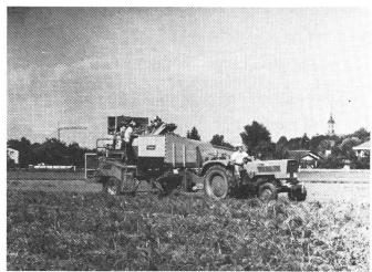
Der Samro SC-Super mit Vorsortierung, 1982 zum ersten Mal im Einsatz, hat sich auf Anhieb klar durchgesetzt. Auf vielfachen Wunsch unserer Kunden wird die Maschine nun auch mit Krautband ausgerüstet. Diese Neuheit wird an der OLMA gezeigt.
