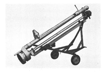
Erforderliche Grubenöffnung ab 45 x 55 cm. Enorme Rührleistung durch höhen- und tiefeneinstellbare Rührdrüse, seitl. schwenkbar bis 290°. Ein überdimensioniertes Schneidwerk verhindert jedes Verstopfen.
