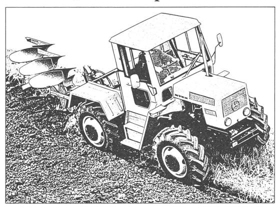
Denn der echte Allradantrieb bringt die Leistung mit dem geringsten Schlupf auf den Boden. Vier gleich große Räder, Hauptgewicht vorn, Differentialsperren in beiden Achsen, Zwangsantrieb aller vier Räder: Damit muß die Kraft auf den Boden, kann sich also nicht den "Weg des geringsten Widerstandes" suchen, nutzlos Schlupf erzeugen und Kraftstoff verbrauchen. Der MB-trac hat den echten Allradantrieb mit vier gleich großen Rädern.
