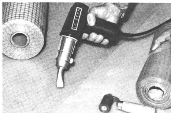
LEISTER beim Schweissen eines Randdefektes an einem PVC-beschichteten Förderband.
