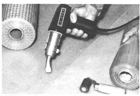
LEISTER beim Schweissen eines Randdefektes an einem PVC-beschichteten Förderband.
