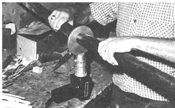
LEISTER beim Stumpfschweissen von Polyäthylen-Rohren.
