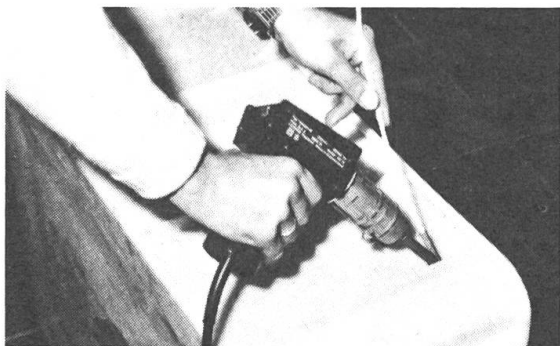
LEISTER beim Reparaturschweissen von einem Polyäthylen-Behälter
