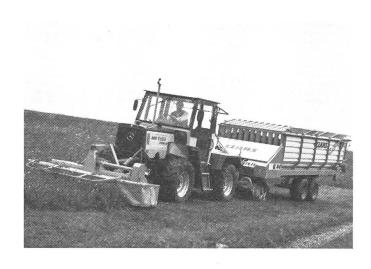
stellbaren Front-, Heck- und Seitenscheiben geliefert. Der MB-trac 700 «Grünland» erreicht z.B. 2,46 m Gesamthöhe mit dieser Fahrerhausvariante. Das Befahren der Ställe zum Beschicken des Futtertisches ist so problemlos möglich. Die MB-trac 700, 800 und turbo 900 sowie 1000 sind jetzt auch mit Spezial-Grünlandbereifung 14,5 R 20 Michelin BIB XM 16 oder 17,5 LR 24 erhältlich.
