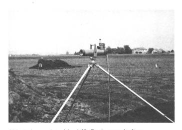
Abb. 1: Laser (strahlen) für Drainagearbeiten.
