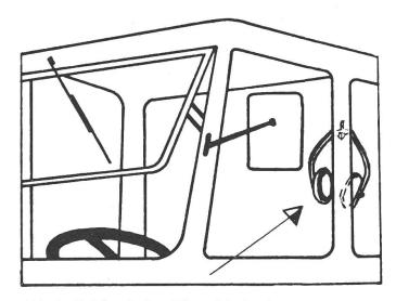
Abb. 6: Gehörschutz griffbereit halten! Ein Gehörschutz, welcher nicht am Arbeitsplatz vorhanden ist, wird nicht getragen. Probleme entstehen besonders beim häufigen Wechsel des Arbeitsplatzes. Der Gehörschutz wird dann gerne «vergessen», wenn er unbequem zum Mitnehmen ist.
