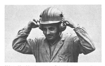
Abb. 5: Kombination von Schutzhelm und Gehörschutzkapseln.
