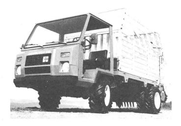
Der neugestaltete Fahrerstand berücksichtigt die Entwicklung im modernen Nutzfahrzeugbau und zeichnet sich durch bequemen Einstieg aus. Die grossdimensionierte Windschutzscheibe sorgt für beste Rundumsicht. Das übersichtlich angeordnete Armaturenbrett mit dem neuen Kombiinstrument gibt dem Fahrer optimale Kontrolle.
