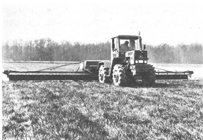
Der Streuer wird in Arbeitsbreiten von 6 – 12 m und mit Trichterinhalt von 1000 oder 1400 l geliefert. Die Ausleger sind aus rostbeständigen Materialien. Der Exaktstreuer wird vollhydraulisch angetrieben und ist ausgerüstet mit einer Fernbedienung zur Mengenregulierung und Seitenabschaltung.
