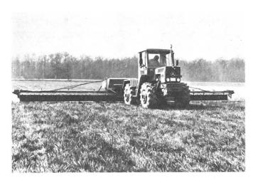
Der Streuer wird in Arbeitsbreiten von 6 – 12 m und mit Trichterinhalt von 1000 oder 1400 l geliefert. Die Ausleger sind aus rostbeständigen Materialen. Der Exaktstreuer wird vollhydraulisch angetrieben und ist ausgerüstet mit einer Fernbedienung zur Mengenregulierung und Seitenabschaltung.
