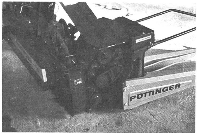
Abb. 6: Einfache Schnittlängenverstellung durch Wechseln der zwei oberen Stirnräder und sehr gute Zugänglichkeit zum Häckselorgan durch Abklappen des oberen Gehäuseteiles.
