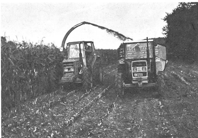
Abb. 1: Wenn im Parallelzug gehäckselt wird, braucht es Häcksler mit einer guten Wurfleistung.
