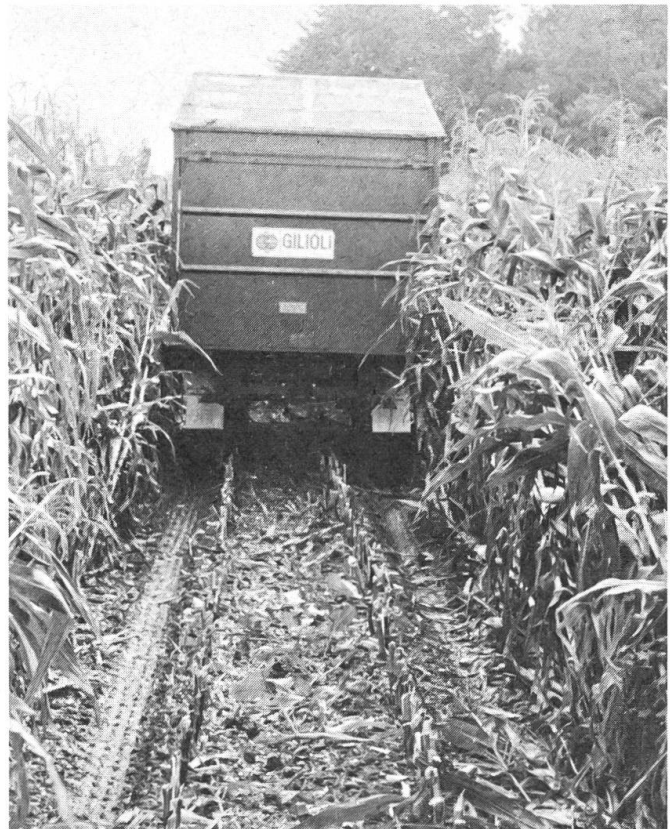
Abb. 2: Mit dem zweireihigen, heckangebauten Maishäcksler kann das Feld in der Ebene ohne grosse Schwierigkeiten angemäht werden.
