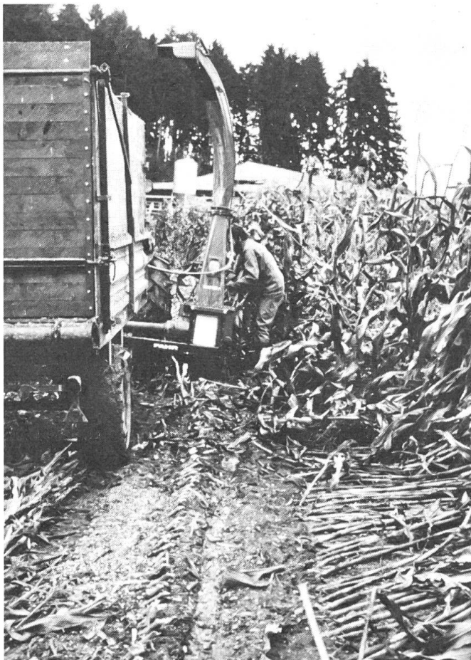
Abb. 5: Eine Rückdrehvorrichtung wird vor allem im Lagermais geschätzt, um Verstopfungen zu beheben.
