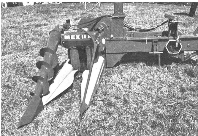
Abb. 4: Eine Lagermaisschnecke kann im Lagermais wertvoll sein. Der Anschaffungspreis von zirka Fr. 1150.– ist hoch.
