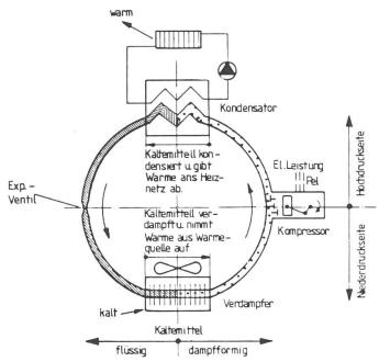
Abb. 3: Funktionsprinzip einer Wärmepumpe
