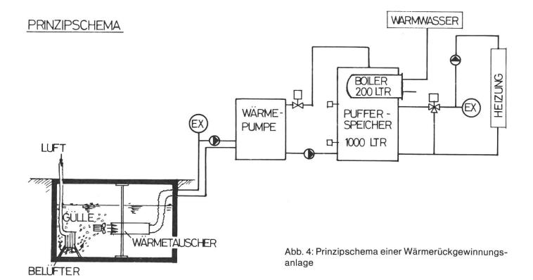
mastplätze gebaut. Die Jauchegrube wurde mit 600 m³ Inhalt reichlich bemessen. Für die Verbesserung der Klimaverhältnisse im Vormaststall sowie für die Beheizung von Werkstatt, Dusche und Futterküche musste eine Heizanlage vorgesehen werden. Im weiteren war genügend Warmwasser für Dusche und Futterküche bereitzustellen.
