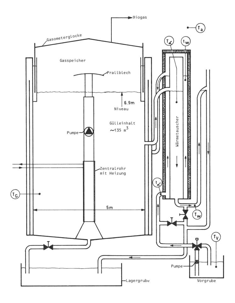
Abb. 1: Biogasanlage mit Wärmetauscher (Temperaturmessstellen siehe Tabelle 1).
