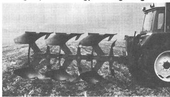
Die geniale Kraftsteuerung der Non-Stop-Steinsicherung bietet wesentliche Vorteile: Schonung von Regelhydraulik. Traktor und Pflug. Sehr grosser Ausweichweg. Keine Probleme in schwerem Boden.
