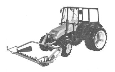
der Anbaukategorie I. Der Polytrac kann somit – je nach Betriebsstruktur und gegebener Geländeform – zusammen mit entsprechenden Frontanbaugeräten – die bisher eingesetzten Zug- und Mähmaschinen für die Rauhfutterernte ersetzen oder ergänzen. Auch in Ackerbaugebieten kann der neue Polytrac – z. B. für Pflegearbeiten – wirtschaftlich eingesetzt werden.
