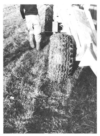
Abb. 5: Abtrift-Messungen. Es wird das seitliche Rutschen der Anhängerräder bezogen auf die Traktorspur registriert.
