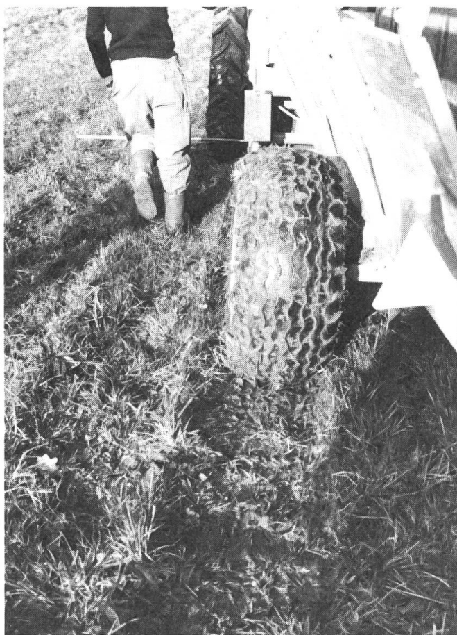
Abb. 5: Abtrift-Messungen. Es wird das seitliche Rutschen der Anhängerräder bezogen auf die Traktorspur registriert.
