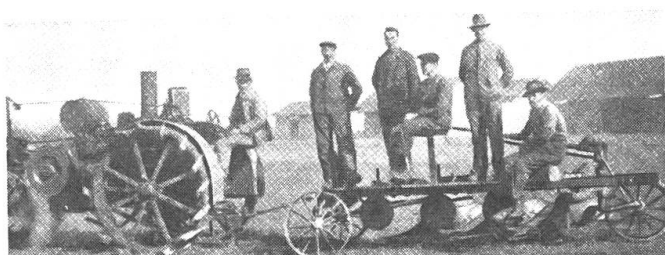
Traktor Mogul (1916), importiert durch IHC, Zürich. 1-Zyl.-Petrolmotor (10/20 PS) mit 2–3scharigem amerik. Beetpflug. Die Aufnahme stammt vom 1. Traktorführerkurs in Frauenfeld.
