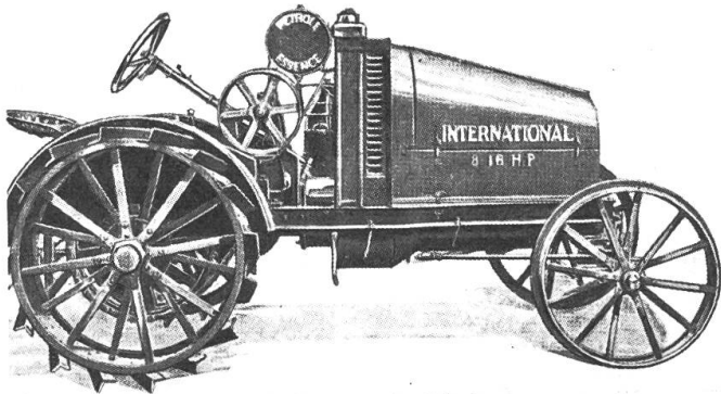
Traktor International 8/16 (1919) , importiert durch die IHC, Zürich. 4-Zyl.-Petrolmotor mit Kettenantrieb.
