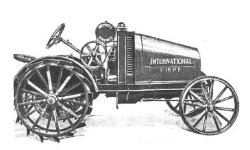
Traktor International 8/16 (1919), importiert durch die IHC, Zürich. 4-Zyl.-Petrolmotor mit Kettenantrieb.
