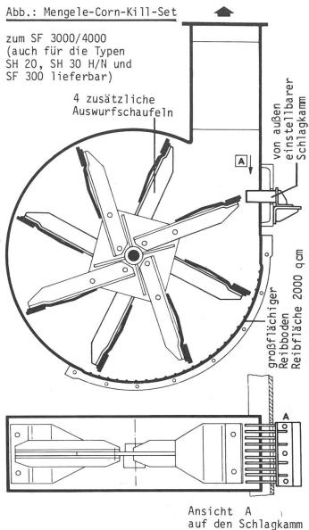
Das neue «Corn-Kill-Set» von Mengele besteht aus 4 bzw. 5 zusätzlichen Auswurfschaufeln (je nach Häcksler-Typ), einem Schlagkamm und einem neuen, noch aggressiveren Reibboden. Mengele liefert dieses «Corn-Kill-Set» im SH 20 serienmässig, für die Scheibenrad-Häcksler SH 30 H, SH 30 N und den Selbstfahrer SF 300 auf Wunsch ebenfalls bei den Trommel-Selbstfahrern SF 3000 und SF 4000. Je nach Typ und Baujahr besteht auch eine Nachrüstmöglichkeit.
