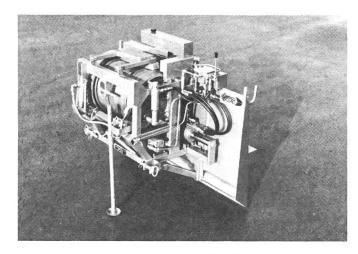
Abb. 5: Hydraulisch-mechanische Dreipunktseilwinde mit patentiertem Seileinzug.
