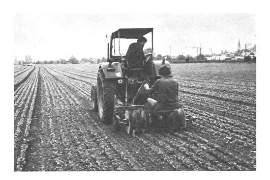
Abb. 4: Die neue Hackbürste für die mechanische Unkrautbekämpfung
