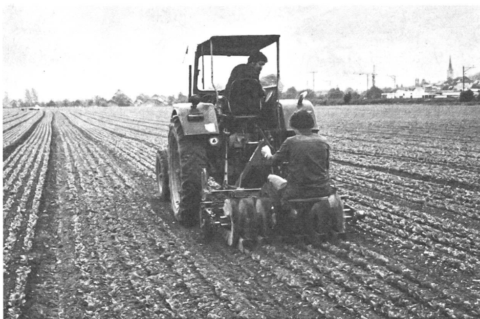
Abb. 4: Die neue Hackbürste für die mechanische Unkrautbekämpfung
