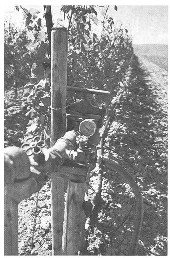
Abb. 4: Filtriervorrichtung zu Anlage für Tropfenberegnung.
