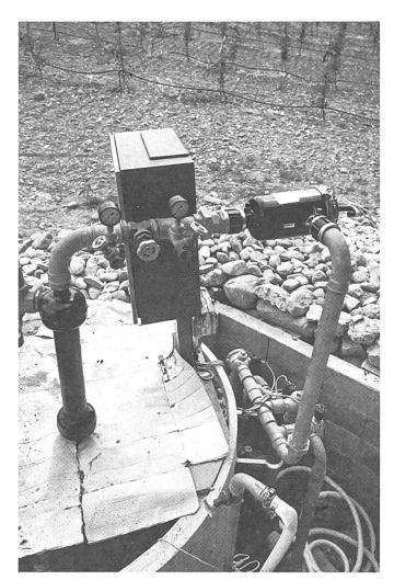
Abb. 5: Filterbatterie und Düsenprogrammierer zu Tropfenberegneranlage in Prangins VD.
