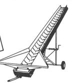
Gummi-Förderbänder Gurt flach, muldenförmig oder Wellenkante
