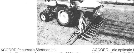
ACCORD Pneumatic Sämaschine einfache Einstellung, Saatmenge von 2 – 360 kg/ha, für Grob- und Feinsaat, höchste Dosiergenauigkeit durch ein Zellenrad, geringe Rüstzeiten, grosse Flächenleistung, Reihen- und Bandsaat (8 cm).
