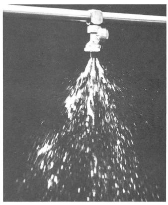
Fig. 4: Dreistrahldüse beim Ausbringen von Flüssigdünger mit groben Tropfen.
