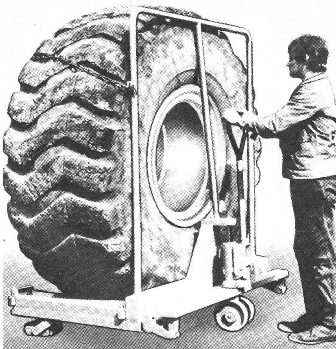
Neuer Radmontagehubwagen für leichten und schnellen Radwechsel an Traktoren, Schwerlastwagen und Baumaschinen (Bild: FTA)
