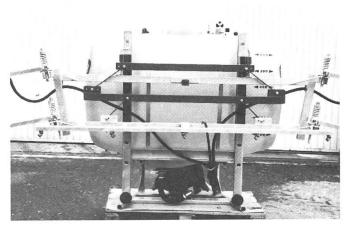
Fig. 3: GRAVIMATIC-Balkenaufhänger mit Doppel-Trapez-Stabilisator
