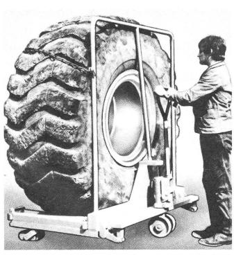
Neuer Radmontagehubwagen für leichten und schnellen Radwechsel an Traktoren, Schwerlastwagen und Baumaschinen (Bild: FTA)
