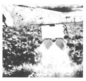
Fig. 1: Zwei Düsengrössen können in diese Fassung eingebaut werden. Schlanke Ausführung mit eingebauten Filtern, Anti-Tropfventilen und Einzel-Absperrventilen, kann auf bestehende Balken montiert werden.
