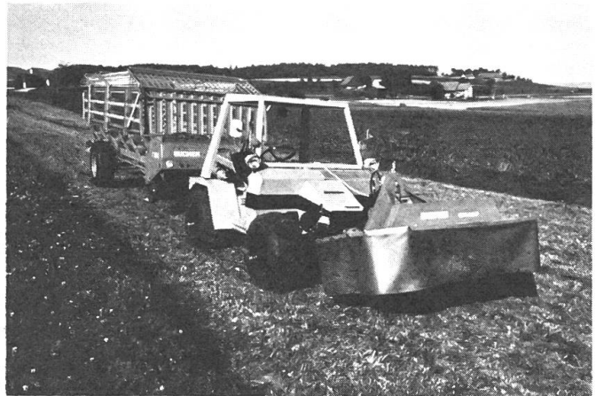
Abb. 1: Starker Zweiachsmäher mit Fronttrommelmäher und angehängtem leichten Ladewagen.
