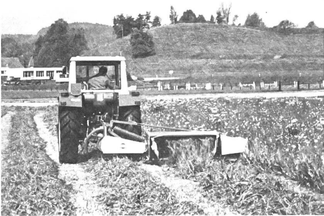
Abb. 2: Mähaufbereiter im Einsatz. Bei lockerer Schwadablage kann oft ein Bearbeitungsgang eingespart werden, da das Futter schon am Schwad gut abtrocknet. Trotzdem gilt: zwei bis dreimaliges Zetten des noch feuchten Futters bringt die schnellste Abtrocknung und geringe Bröckelverluste.
