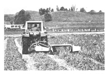
Abb. 2: Mähaufbereiter im Einsatz. Bei lockerer Schwadablage kann oft ein Bearbeitungsgang eingespart werden, da das Futter schon am Schwad gut abtrocknet. Trotzdem gilt: zwei bis dreimaliges Zetten des noch feuchten Futters bringt die schnellste Abtrocknung und geringe Bröckelverluste.
