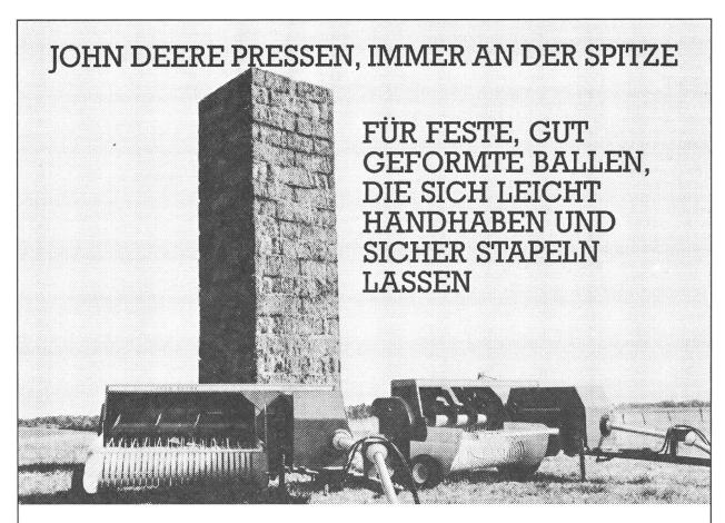
Die Pressen von John Deere sind technisch ausgereift und liefern Ballen in Bestform. Auch beim Sta-peln, Werfen, Transportieren verlieren sie nicht die Form. Der kontinuierliche Materialfluss beginnt bereits an der Pick-up. Zusätzliche Zinken und Leitbleche sorgen dafür, dass auch breite Schwade aufgenommen werden
