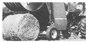
Die Vorverdichtung durch die neuen, einstellbaren Niederhalter, beginnt direkt an der Pick-up und bleibt stets konstant, unabhängig sowohl von der Höheneinstellung als auch von möglichen Boden-
