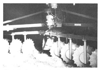
**Abb. 7:** Die Sternradfräse hat sich von den zurzeit auf dem Schweizermarkt erhältlichen Entnahmefräsen für Kurzschnittladewagenfutter am besten bewährt. Die Entnahmeleistung liegt bei 10 bis 40 kg/min, je nach Schnittqualität des Futters.
