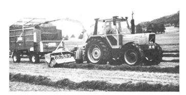
**Abb. 1:** Feldhäckslerverfahren. Notwendiger Traktor 66 kW (90 PS), Automatikwagen 10 m³.
