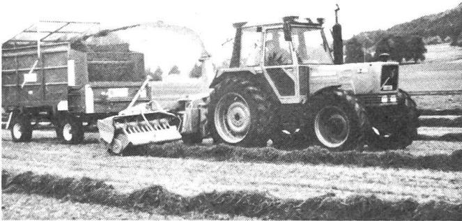
Abb. 1: Feldhäckslerverfahren. Notwendiger Traktor 66 kW (90 PS), Automatikwagen 10 m 3 .
