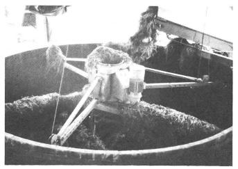
**Abb. 5:** Bei grösseren Silodurchmessern ist das einwandfreie Verteilen des Futters von grosser Bedeutung, besonders wenn mechanisch entnommen werden soll. Funktionshöhe dieses mechanischen Verteilgerätes: 1,5 m.
