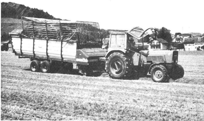
Abb. 2: Kurzschnittladewagen. 25 Messer, 23 m 3 . Traktor mit 40 kW (55 PS) genügt.
