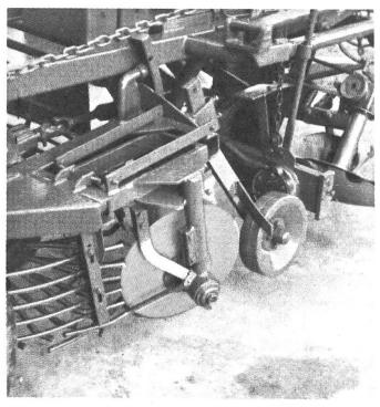
Einzelheiten der neuen Rodegruppe mit rotierender Scheibenschar. Diese Vorrichtung erlaubt das Arbeiten unter sonst unmöglichen Verhältnissen.
