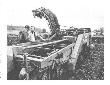
rigens eine Achse, die von der Traktorkabine aus hydraulisch gesteuert werden kann. Auch alle anderen hydraulischen Funktionen werden von der Kabine aus betätigt, so dass sich die Maschine für den Einmann-Betrieb bestens eignet.
