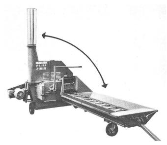
Abladehäcksler jetzt mit einem hochklappbaren Zubringertrog lieferbar. Wird der Häcksler nicht gebraucht, so lässt sich der Zubringertrog mit wenigen Handgriffen hochklappen. Dadurch werden der Platz um den Häcksler und eine allfällige Durchfahrt wieder frei, ohne dass die Maschine ihren Standort wechseln muss. (Bucher-Guyer)
