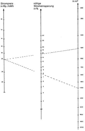
Beispiel: Bei einem Strompreis von 20 Rp./kWh und 1000 m³ Stockinhalt müssen ca. 8% der bisherigen Stromkosten bzw. Ventilatorstunden eingespart werden, um die Mehrkosten der autom. Steuerung zu decken. Bei 500 m³ Stockinhalt sind es ca. 16%.
