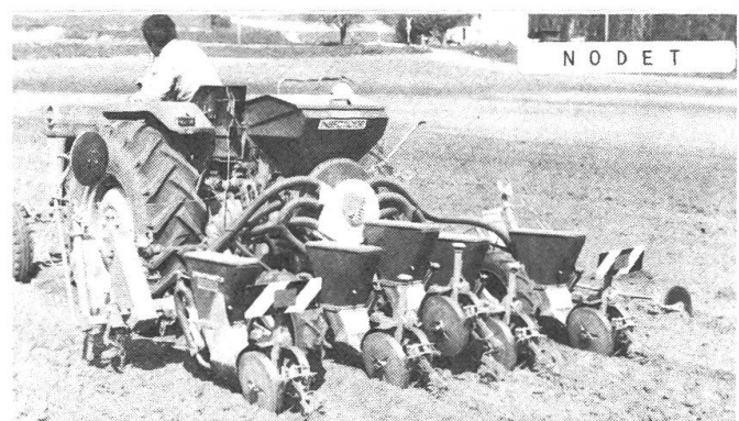
Abb. 5: Maissaat mit den pneumatischen Einzelkornsämaschinen im Moorboden. Die einteiligen Walkgummi-Druckrollen (Becker, Hassia: links) brachten gegenüber den übrigen Lösungen keine messbaren Vorteile.
